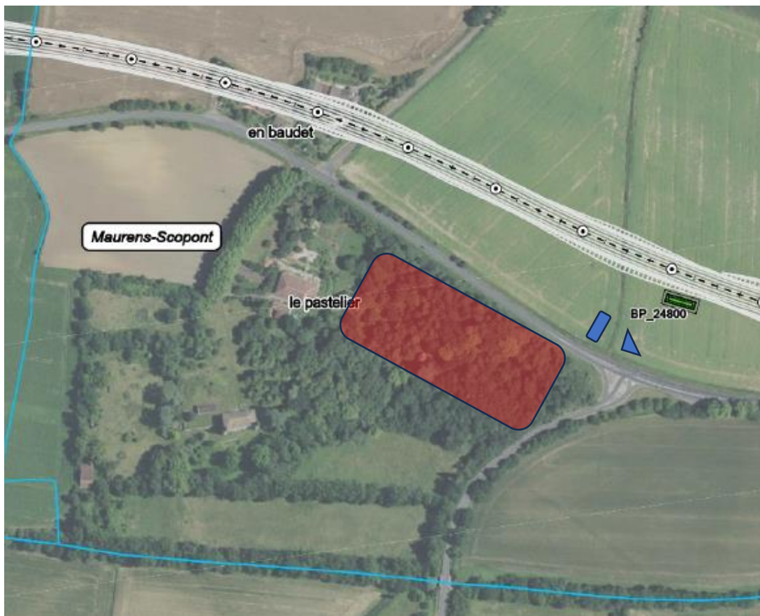
Figure 96: Plan ATOSCA donnant la position du BP24800. En rouge la zone humide du château de Scopont (tracé rajouté). En bleu, les 2 bassins implantés pour remplacer le BP24800 (rajoutés) – MAURENS-SCOPONT (81).
